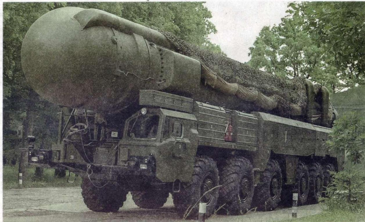
Самходная пусковая установка ПГРК «Пионер» на шасси МАЗ-547В.
